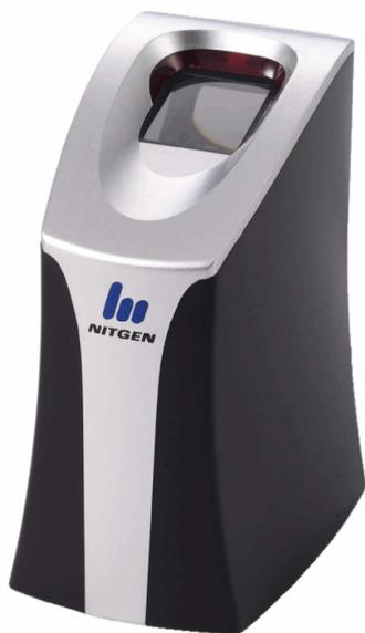
El Hamster II es un sensor de huella digital de alta precisión que se conecta al ordenador a través de una interfaz USB, como cualquier periférico, y se usa en todas las áreas de acceso restringido, mejorando la seguridad, ya que elimina la necesidad de utilizar contraseñas, que puede ser olvidadas o compartidas con usuarios no autorizados.
